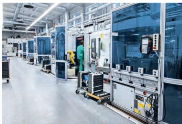
Geiger setzt seit langem auf automatisierte Fertigungslinien mit NZX-Maschinen von DMG MORI.
