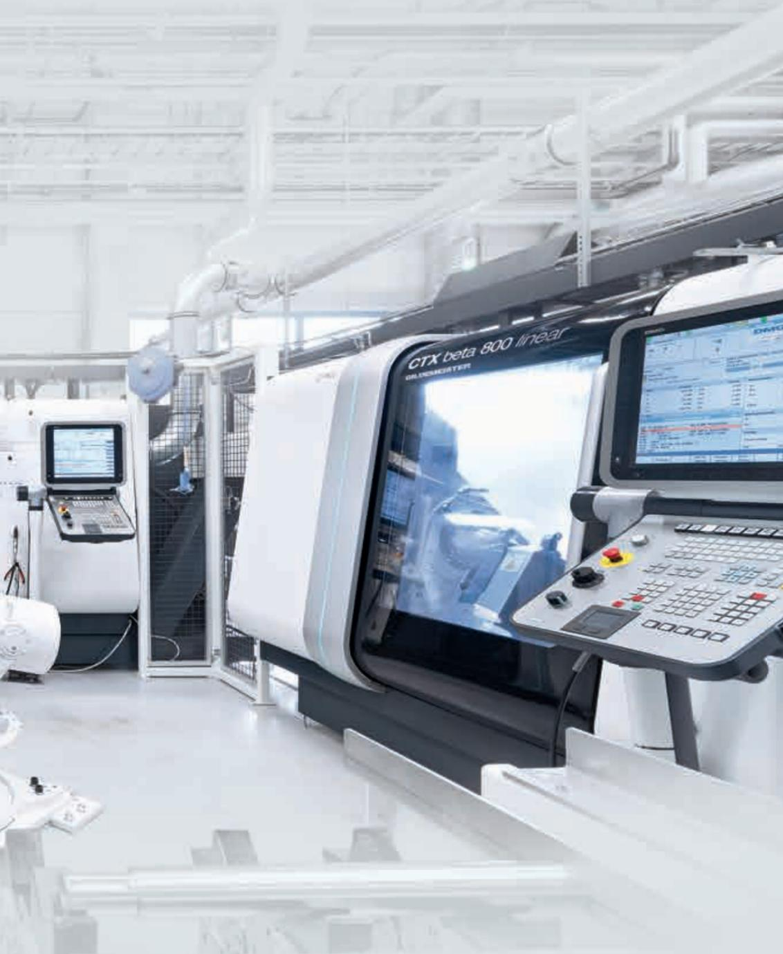
Xylem bearbeitet auf der flexiblen Fertigungszelle Wellen für Schmutzwasserpumpen – Schruppbearbeitung, Drehvorgänge, Feinbearbeitung sowie Nut- und Bohrungsfräsen. Durch die automatische Korrektur der Maße kann die Qualitätskontrolle am Ende entfallen.
