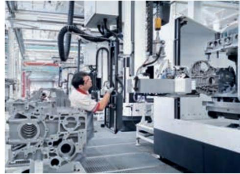
Am Rüstplatz werden die Bauteile beladen.
