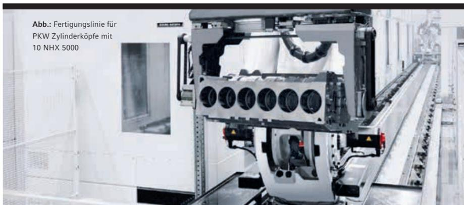
Abb.: Fertigungslinie für PKW Zylinderköpfe mit 10 NHX 5000
