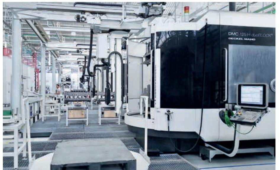
Bei FPT Industrial Argentina S.A. hat DMG MORI Systems eine Fertigungslinie mit insgesamt 13 DMC-Bearbeitungszentren als Turn-Key Projekt konzipiert.
