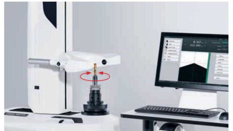
**Zum automatischen Scharfstellen der Schneide.** Motorisch betriebene Spindel, mit Komfort-Systemschrank und 24"-Touch-Display im Standard.
