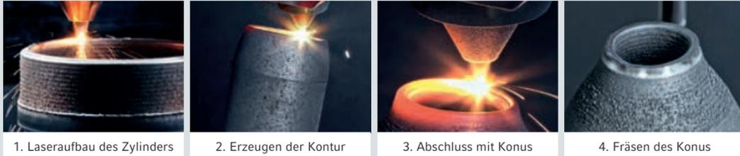
1. Laseraufbau des Zylinders
