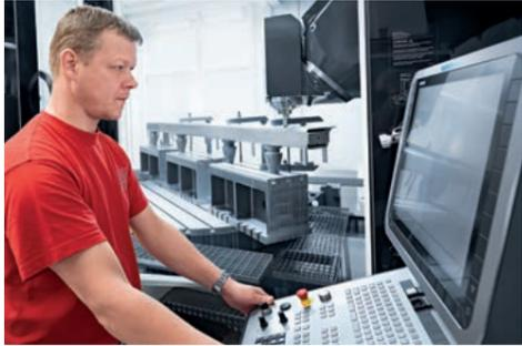
5-Achs-Simultanbearbeitung von Großbauteilen auf der DMU 340 P.
