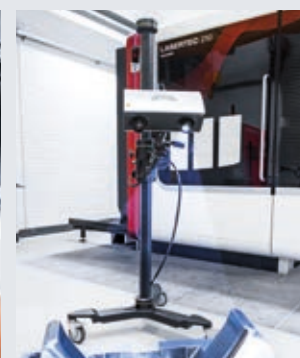
Vermessen der Werkzeug- geometrie mittels 3D-Scanner.
