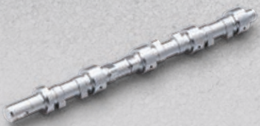
6 ø 40 × 470 mm Nockenwelle Material: GG25
