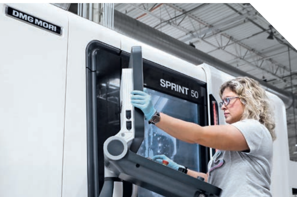
Bedienerin Erica Williams an der SPRINT 50. Die Produktionsdrehmaschine ermöglicht Automatendrehen von der Stange und von Futterteilen mit bis zu 36 Werkzeugstationen.
