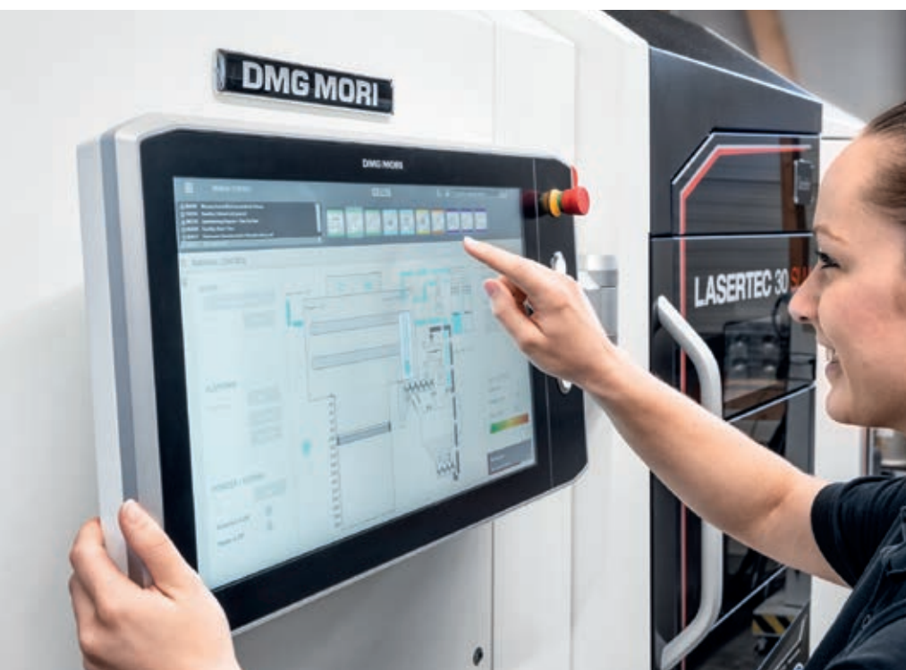
Die LASERTEC 30 SLM 2. Generation ist mit der einheitlichen Steuerungs- und Bedienoberfläche CELOS ausgestattet.
