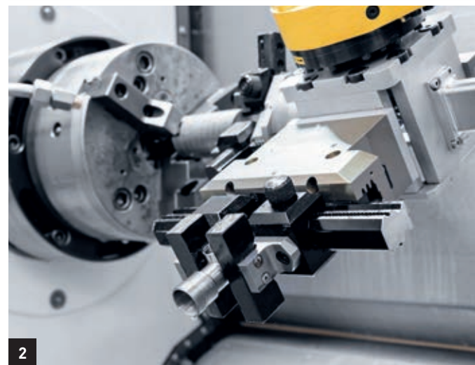
1. Das Magazin des Robo2Go bietet Platz für 72 Werkstücke. 2. Der Robo2Go entnimmt die Fertigteile an der Gegenspindel und bestückt die Hauptspindel mit neuen Rohteilen – völlig autonom.
