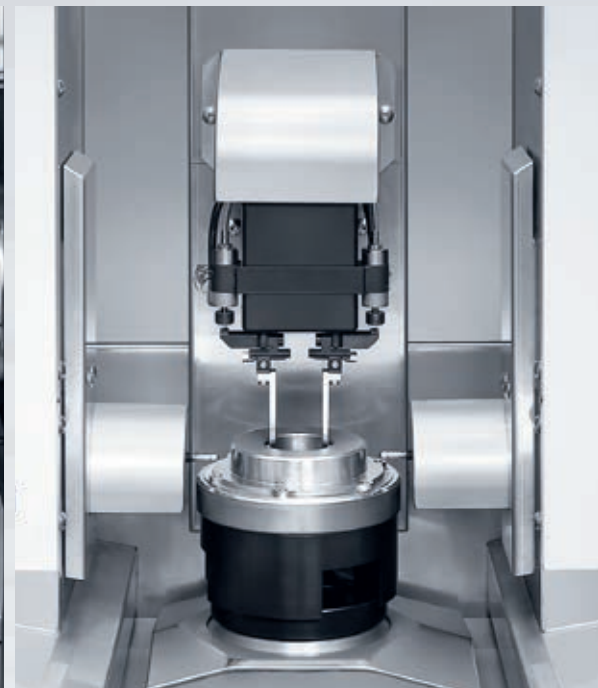
Messstation für das hauptzeitparallele In-Prozess Messen.
