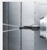
Kühlmittelzuführung durch die Spindel
