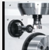
Automatischer, maschinenintegrierter Werkzeug-Voreinsteller
