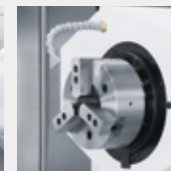
Kühlmittel oberhalb Spannutter (Spindel rechts)
